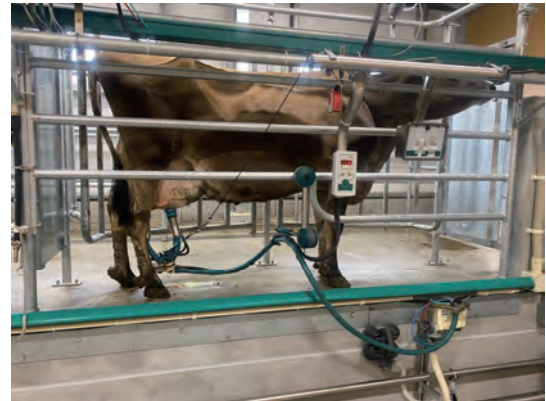
過搾乳のリスクを減らす自動離脱方式のオートタンデムパーラー。
