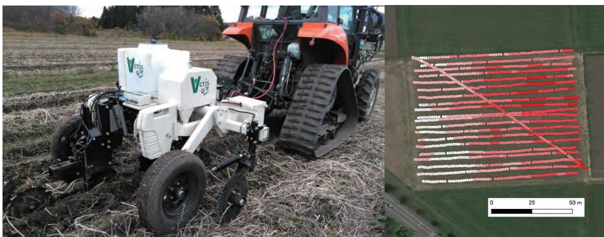
走行型土壌分析装置による自動測定とデジタルデータによる圃場地力マップの作成
