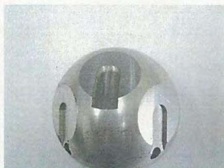
図4 圧力センサー取付け球
